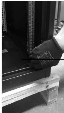
Der entfernte Stift wird auf der gegenüber liegenden Seite montiert
