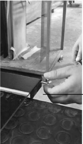
Die Scharnierteile am oberen Teil der Tür werden entfernt.
