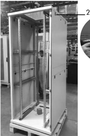
Teile des Mechanismus-Stangenhalters werden entfernt.
