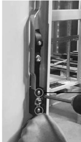
Die Verriegelung wird durch Lösen der 2 oben gezeigten Schrauben entfernt
