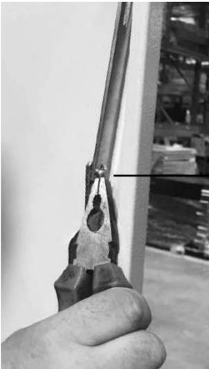
Die Segmente, die das verbindende Element der Mechanikstange und des Schlosses sind, werden entfernt.
