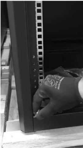
Der darunter liegende Stift wird durch Drehen entfernt
